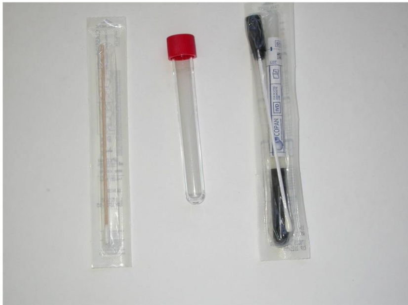
Obrázek 11: Různé typy stěrových tamponů. Vlevo suchý tampon, uprostřed zkumavka na exponovaný suchý tampon, vpravo stěrová souprava a zkumavka s transportní půdou (foto: J.Bzdil).
