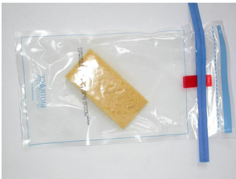
Obrázek 13: Odběrová souprava se stěrovou abrazivní houbičkou, kterou lze stírat vyšetřované povrchy v terénu a v laboratoři mikrobiologicky vyšetřit (foto: J. Bzdil).
