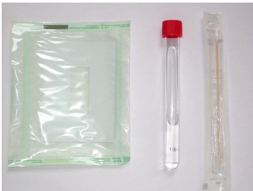
Obrázek 12: Stěrová souprava pro odběr materiálu z přesně definované plochy. Vlevo je sterilní šablona, uprostřed transportní zkumavka s roztokem a vpravo je stěrový tampón (foto: J. Bzdil).
