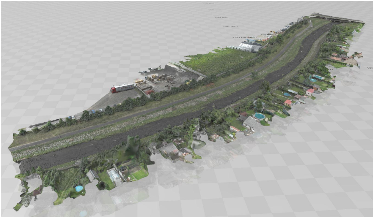
Obr. 11: Příklad užití dronu při mapování části vodního toku pro následné vytvoření 3D modelu. Zdroj: www.prolabengineering.com
