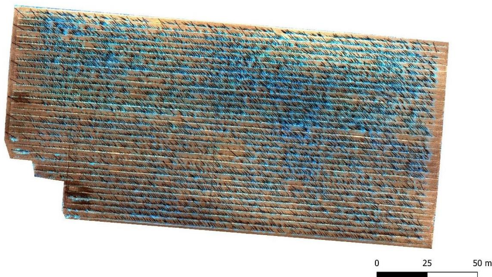
Obr. X: Syntéza v nepravých barvách (RED-RED EDGE-NIR). Snímek chmelnice je pořízen kamerou MicaSense RedEdge-P umístěnou na WingtraOne GEN II.
