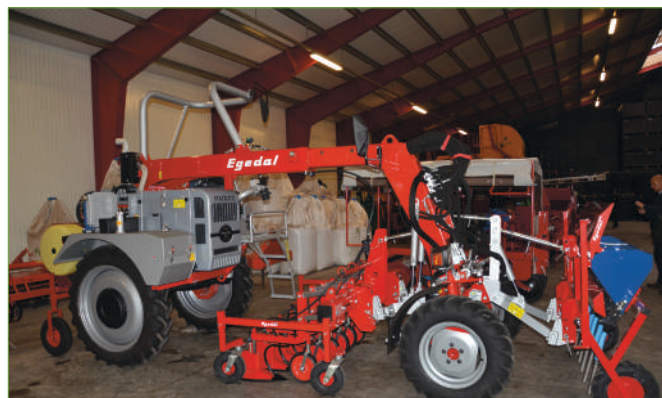
Obr. 3: Speciální nosič meziřádkového postřikovače a kultivačních adaptérů pro kombinaci pletí a herbicidního ošetření.
