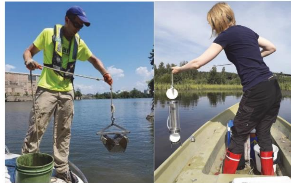
Obr. 13 - Praktická ukázka odběru vzorků sedimentů z plné vodní hladiny.
